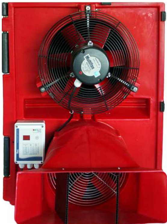
Régulateur monté sur le récupérateur
